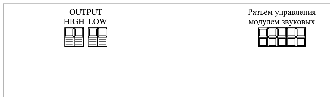
Рис. 1. Схема расположения разъёмов на задней стенке MOBILE-60
